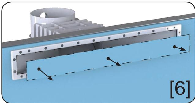
A l'aide d'un cutter, découpez le liner à l'intérieur de la bride. Enlevez la chute de liner.
